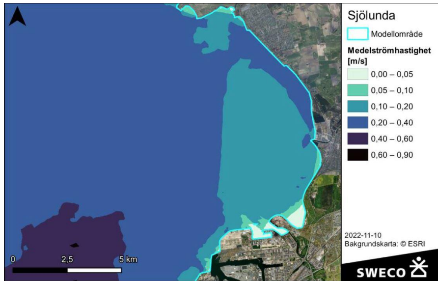
Figur 7-2. Medelströmshastighet under hela modellsimuleringen utan nya utloppsledning (bild från Sweco, 2023b).
