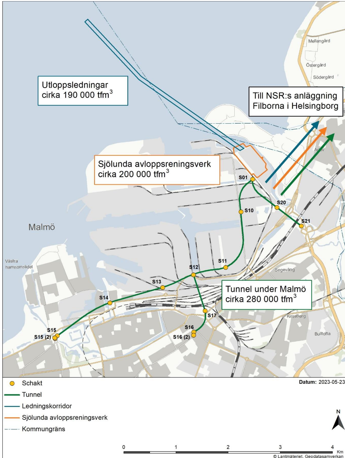
Figur 7-1. Kartan beskriver läget av utloppsledning, Sjölunda avloppsreningsverk och tunneln under Malmö. Muddringen av läget för utloppsledning beräknas ge upphov till cirka 190 000 teoretiska fasta m^3 massor. Anläggande av Sjölunda avloppsreningsverk beräknas ge upphov till cirka 200 000 t\text{fm}^3 massor. Schaktning och tunneldrivning beräknas ge upphov till cirka 280 000 t\text{fm}^3 massor. Alla massor planeras i dagsläget transporteras till NSR:s anläggning Filborna i Helsingborg eller annan godkänd mottagare.
