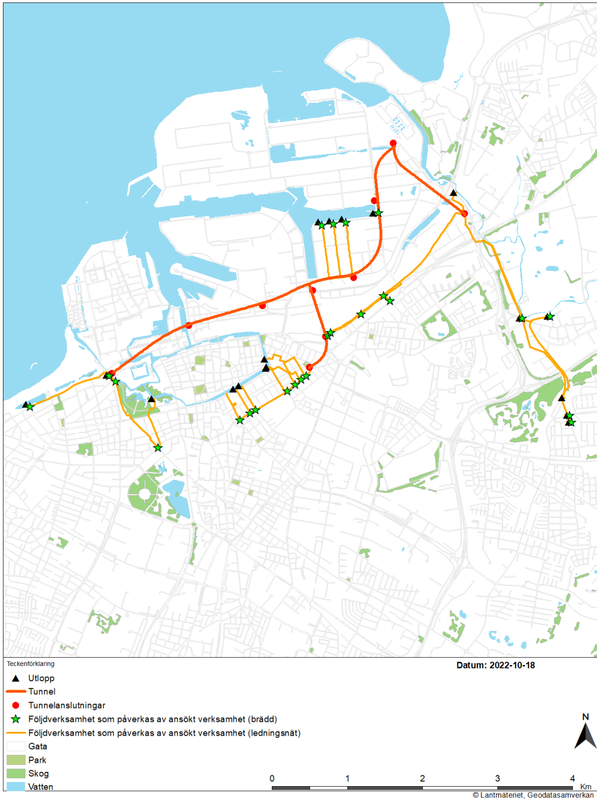
Figur 7-1. Bräddavlopp, spillvattenledningar från bräddavlopp till tunnelanslutning, bräddledningar från bräddavlopp till utlopp i recipient samt utloppen.
