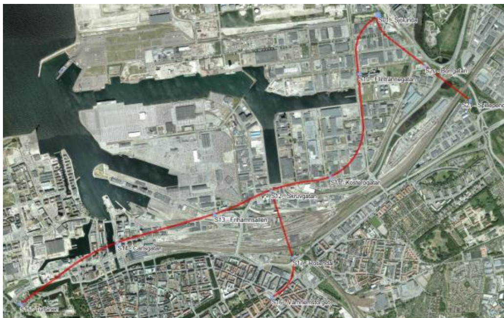
Figur 7-4. Översikt över lokalisering tunnel, mikrotunnlar och schakter.
