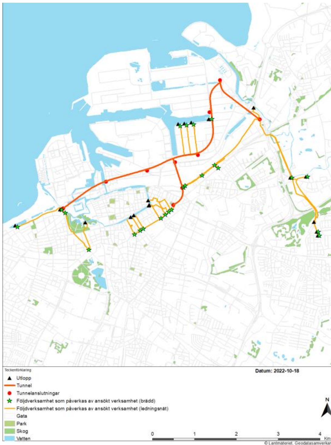
Figur 4-1. Bräddledning och bräddpunkter som berörs av tunnelsystemet.
