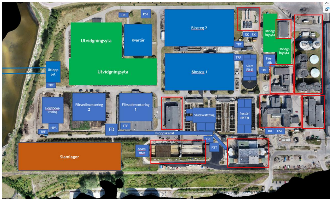
Figur 22 Byggnadsverk som behålls helt eller delvis, markerade med röd ram, samt planerade nya byggnadsverk markerade i blått. Grön markering avser ytor avsatta för framtida expansionsmöjligheter och orange markering yta avsatt för möjlighet till framtida slamförbränning (ingår inte inom ramen för tillståndsansökan). Observera att placeringarna är preliminära och kan komma att ändras i det fortsatta arbetet med utbyggnadsförslag och genomförandeplan.
